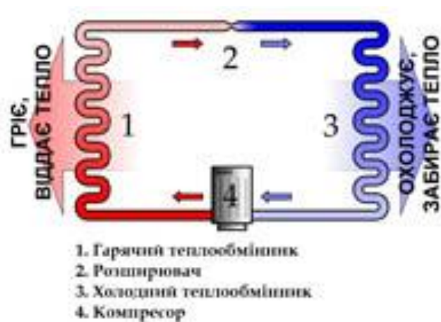
Рис. 1.2. Принципова схема теплового насосу.
